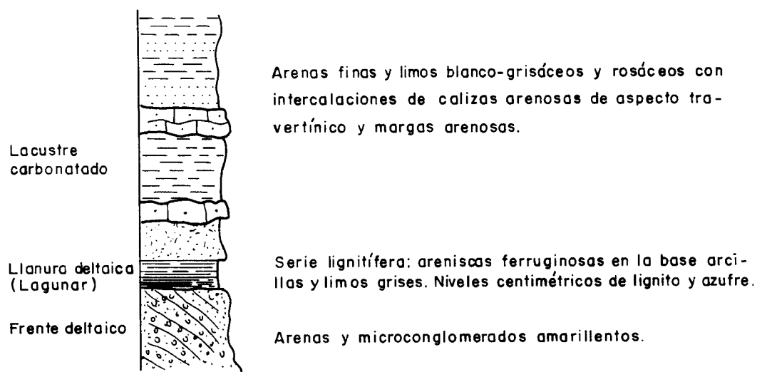
Fig. 32.- Columna sintética de la Rambla de Jalbos
